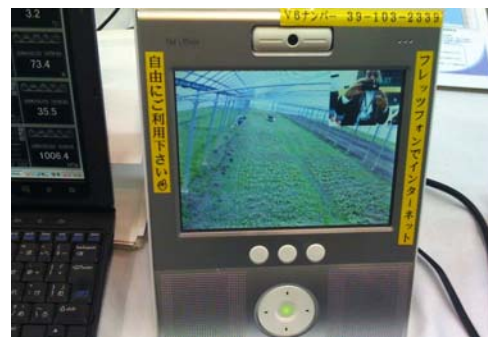
フィールドサーバーから送られる映像を IP テレビ電話で確認
